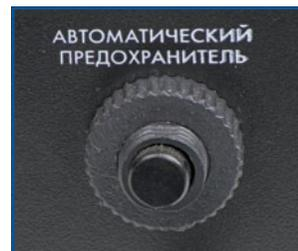
Автоматический предохранитель от короткого замыкания и перегрузки, не требующий замены в случае срабатывания.
