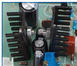
Радиаторы охлаждения полупроводниковых элементов — улучшенное охлаждение и облегчение работы блока управления.
